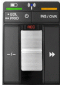
Schiebeschalter Aufnahme, Stopp, Wiedergabe und Rücklauf
