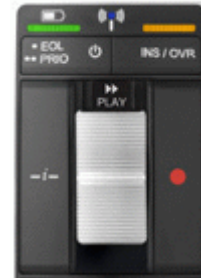
Schiebeschalter schneller Vorlauf, Wiedergabe/Aufnahme, Stopp, Rücklauf
